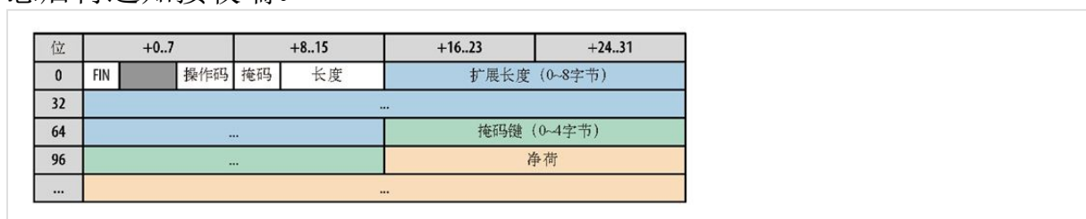
图17-1：WebSocket帧格式：2~14字节+净荷
